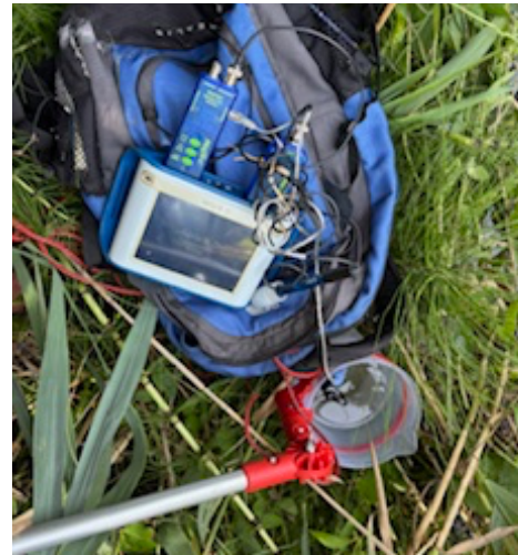
Figura 23 - Analisi dell'acqua con la sonda PASCO® effettuato presso "Novazzano palude" (Giona Gaggini)
