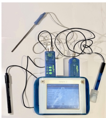
Figura 20 - Sonda PASCO con sensori di temperatura, pH e conducibilità
