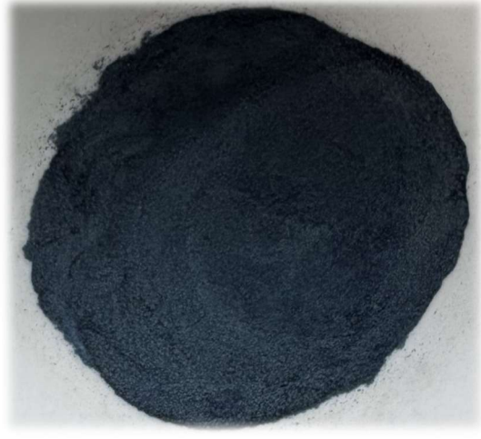
Figura 5.3 31 : Campione nel mortaio dopo la macinazione
