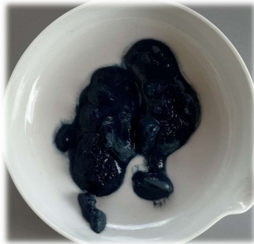
Figura 5.4 31 : Campione pronto per la seconda cottura
