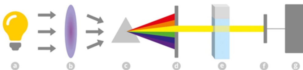
Figura 2.14: Struttura spettrofotometro: (a) fonte di luce, (b) collimatore, (c) monocromatore (prisma/reticolo), (d) fenditura selettiva / d'uscita, (e) cuvetta, (f) rivelatore, (g) lettore [59]
