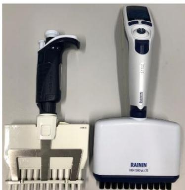
Immagine 10: pipette multicanali. A sinistra la pipetta manuale con volume massimo di 200 $\mu$ L e a destra quella automatica con volume regolabile da 100 $\mu$ L a 1200 $\mu$ L
