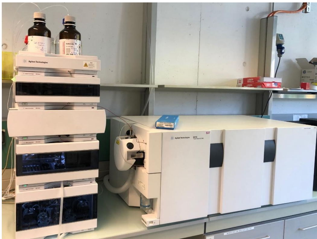
Figura 6.5.2.1.q: La macchina per fare la cromatografia liquida ad alte prestazioni abbinata alla spettrometria di massa a triplo quadrupolo (HPLC- MS/MS)
