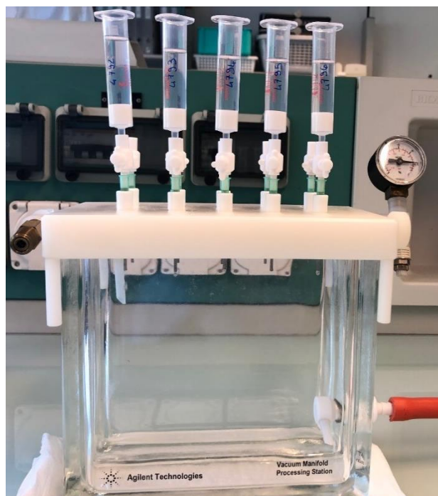
Figura 6.5.2.1.e: Vacuum manifold processing station (serve per tirare a secco aiutandosi con il vuoto) con attivazione delle colonnine SPE con metanolo, acqua ultrapura e acqua acida.
