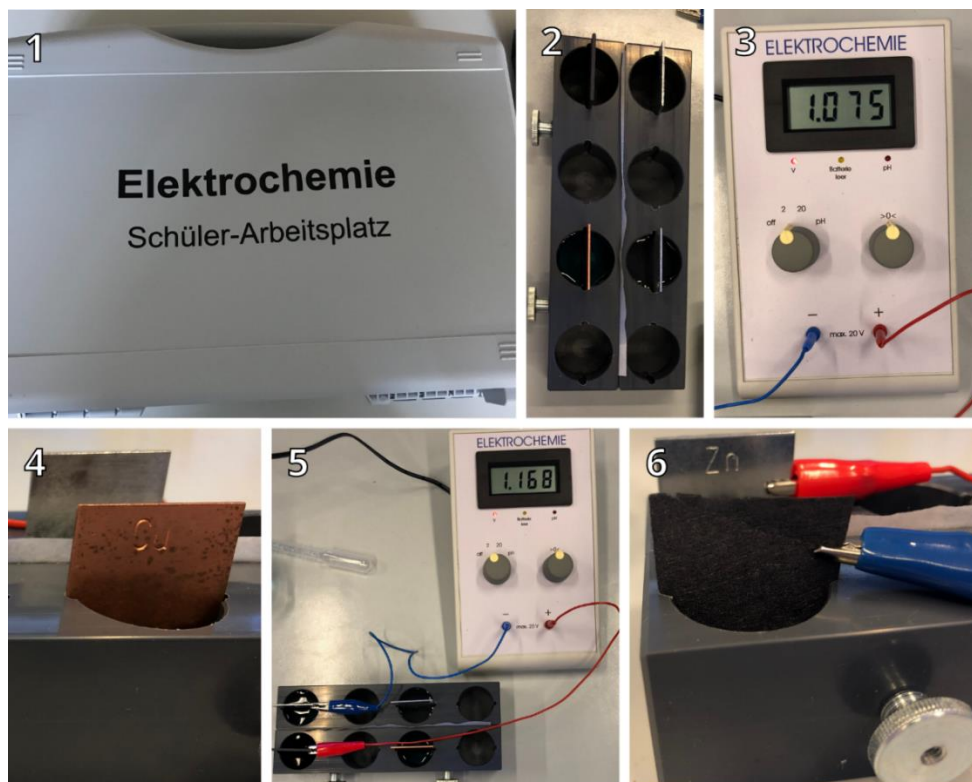
1. Kit didattico di elettrochimica. 96 2. Sistema di celle dove sono stati svolti gli esperimenti. 3. Voltmetro con la misura del voltaggio della cella zinco-rame. 4. Elettrodo di rame da vicino immerso nella sua semicella. 5. Il sistema completo con la cella zinco-grafite e il voltmetro collegato. 6. Dettaglio sul foglio di grafite che funge da elettrodo nella cella zinco-grafite.
